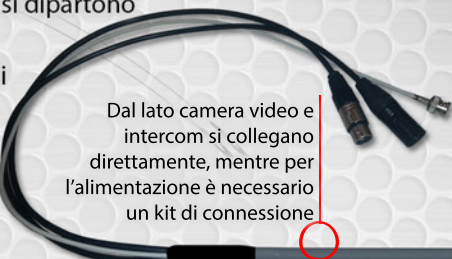
L'interfaccia in regia razionalizza le connessioni e fornisce l'alimentazione, fino a tre camere
